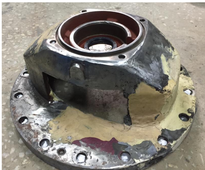
Рисунок 22 – Промежуточный фонарь горизонтального центробежного насоса, восстановленный до мастер-модели
