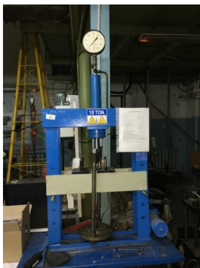
Рисунок 11 – Пресс для проведения испытаний на растяжение
