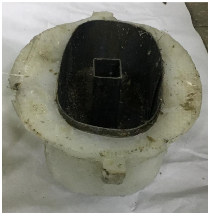
Рисунок 25 – Отливка формы внутренней поверхности промежуточного фонаря из литейного силикона
