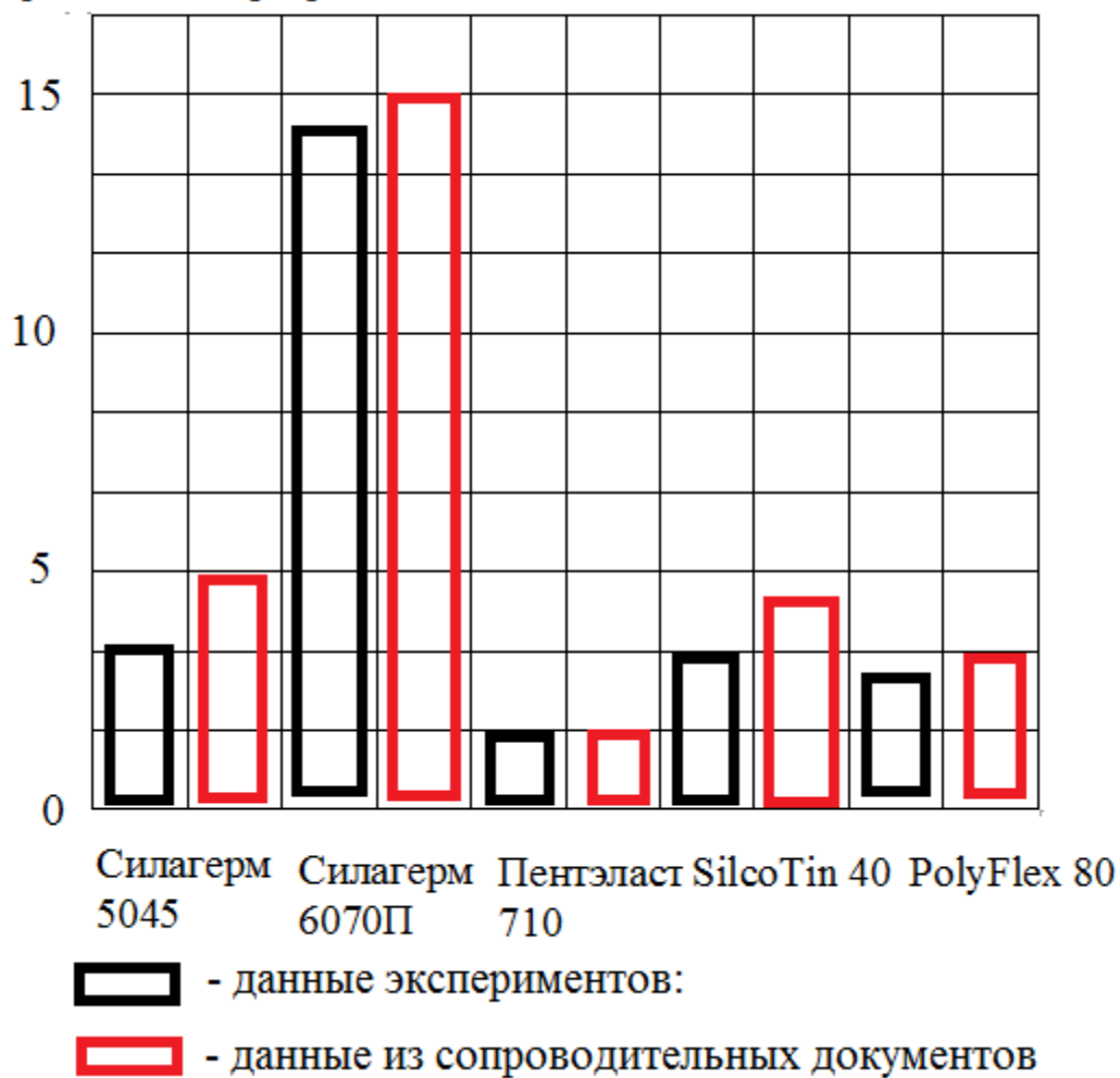
Рисунок 13 – Сравнительная диаграмма прочности на разрыв данных замеров и из сопроводительных документов
