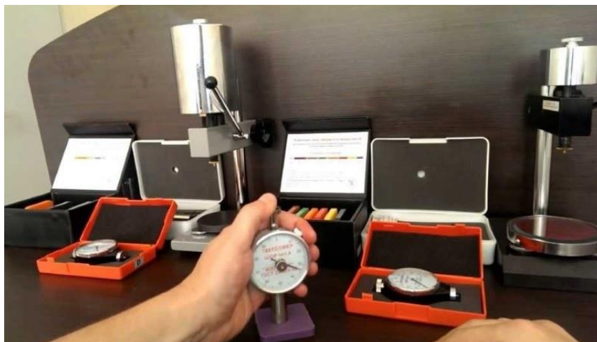
Рисунок 9 – Произведение измерений по методу Шора
