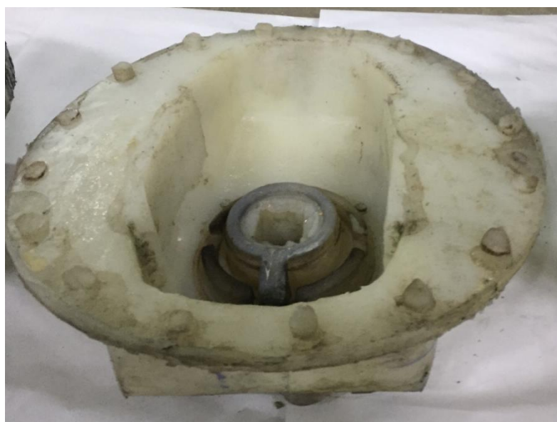
Рисунок 24 – Отливка формы внешней поверхности промежуточного фонаря из литейного силикона
