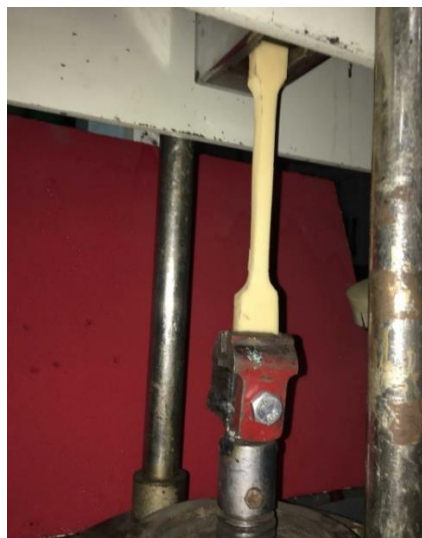
Рисунок 11 – Пресс для проведения испытаний на растяжение
