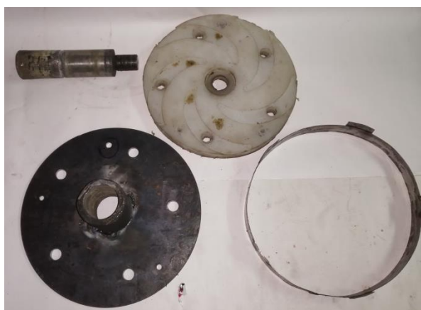
Рисунок 20 – Литейный комплект для облицовки рабочего колеса
