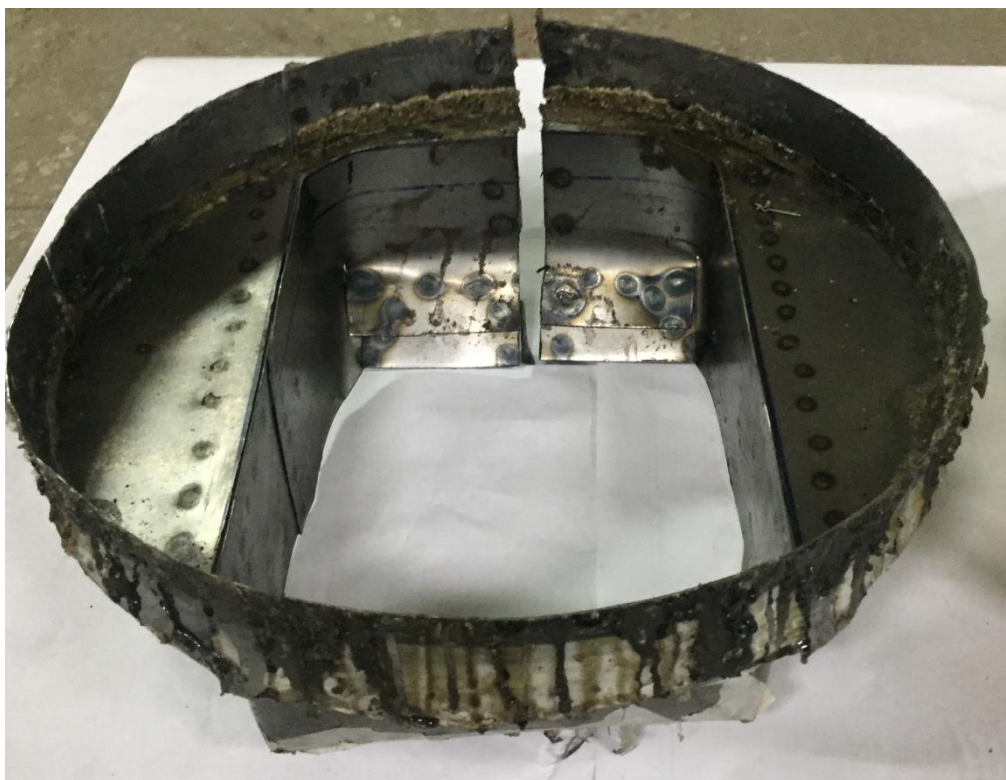
Рисунок 23– Обечайка для формирования внешней поверхности промежуточного фонаря
