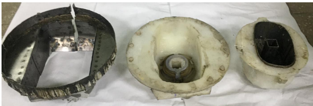
Рисунок 26 – Литейный (модельный) комплект для отливки промежуточного фонаря
