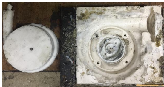
Рисунок 15 – Комплект литья половинки корпуса улиты насоса ЦН180
